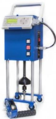
Прибор ПСИ-МГ4 предназначен для определения адгезии изоляционного покрытия к поверхности трубопроводов отслаиванием при контроле качества изоляционных работ в полевых и заводских условиях в соответствии с ГОСТ 52568, ГОСТ ИСО 9.602 и ГОСТ ИСО 21809-1.
