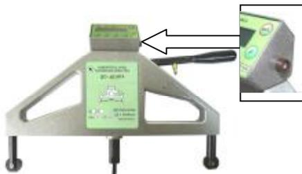
Рисунок 1 – Место пломбирования от несанкционированного доступа
