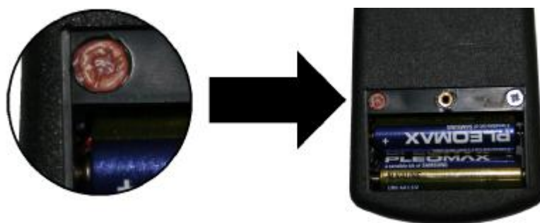
Рисунок 2 – Место пломбирования от несанкционированного доступа
