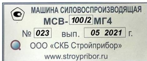
Маркировка машин выполнена в виде несмываемой наклейки, закрепленной на шкафу управления, на силовой раме и вторичном преобразователе, на которой нанесено:
