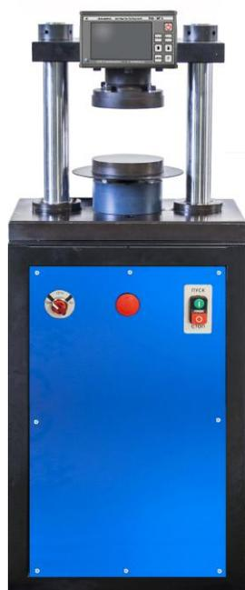
Рисунок 4 – Общий вид машин испытательных ПМЭ-50МГ4 и ПМЭ-100МГ4
