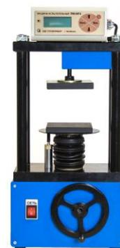
Рисунок 6 – Общий вид машин испытательных ПМР-МГ4
