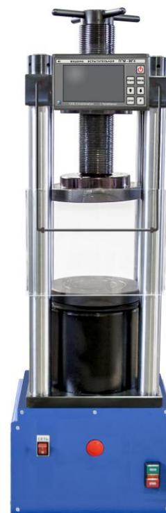
Рисунок 3 – Общий вид машины испытательной ПГМ250.А-МГ4
