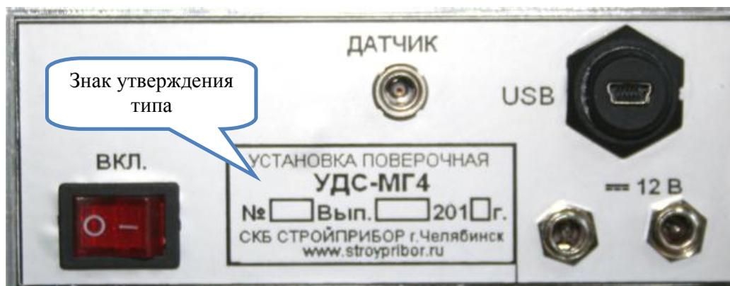
Рисунок 2 – Задняя панель электронного блока УДС-МГ4
