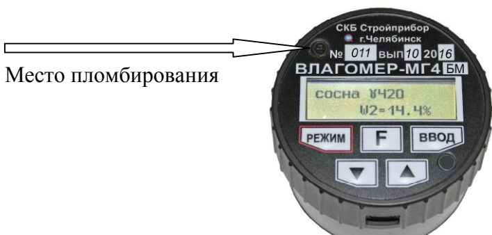
Рисунок 1 - Общий вид измерителя влажности ВЛАГОМЕР-МГ4М
